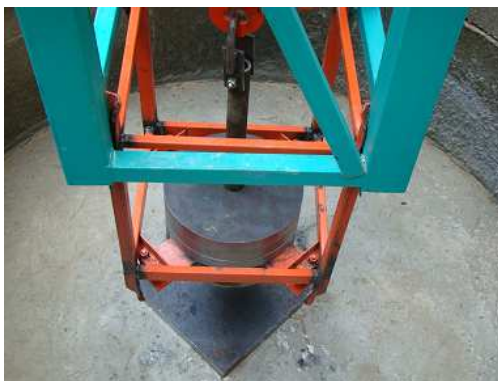
Рис. 2.2: Направляющая система, груз и наковальня.
