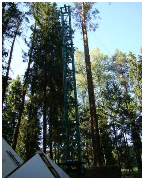
Рис. 2.1: Фотография вышки, используемой для осуществления процесса механического удара.
